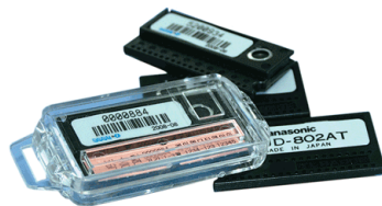
รูปแสดง OSL เครื่องบันทึกปริมาณรังสีประจำตัวบุคคล
